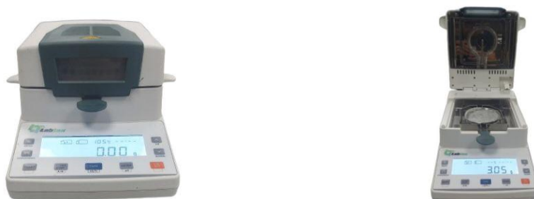
Рисунок 1. Определение концентрации химической добавки с помощью анализатора влажности
